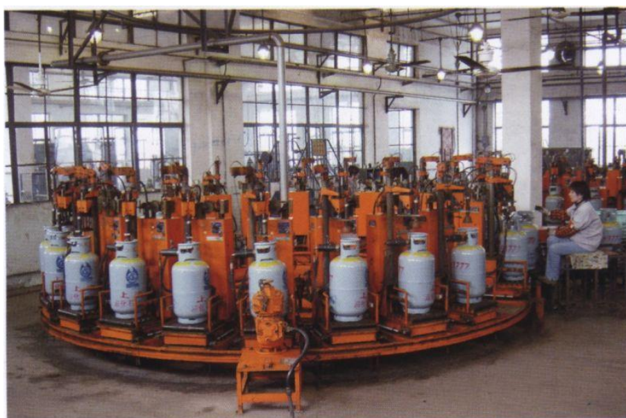
图 3 液化石油气瓶充装流水线
